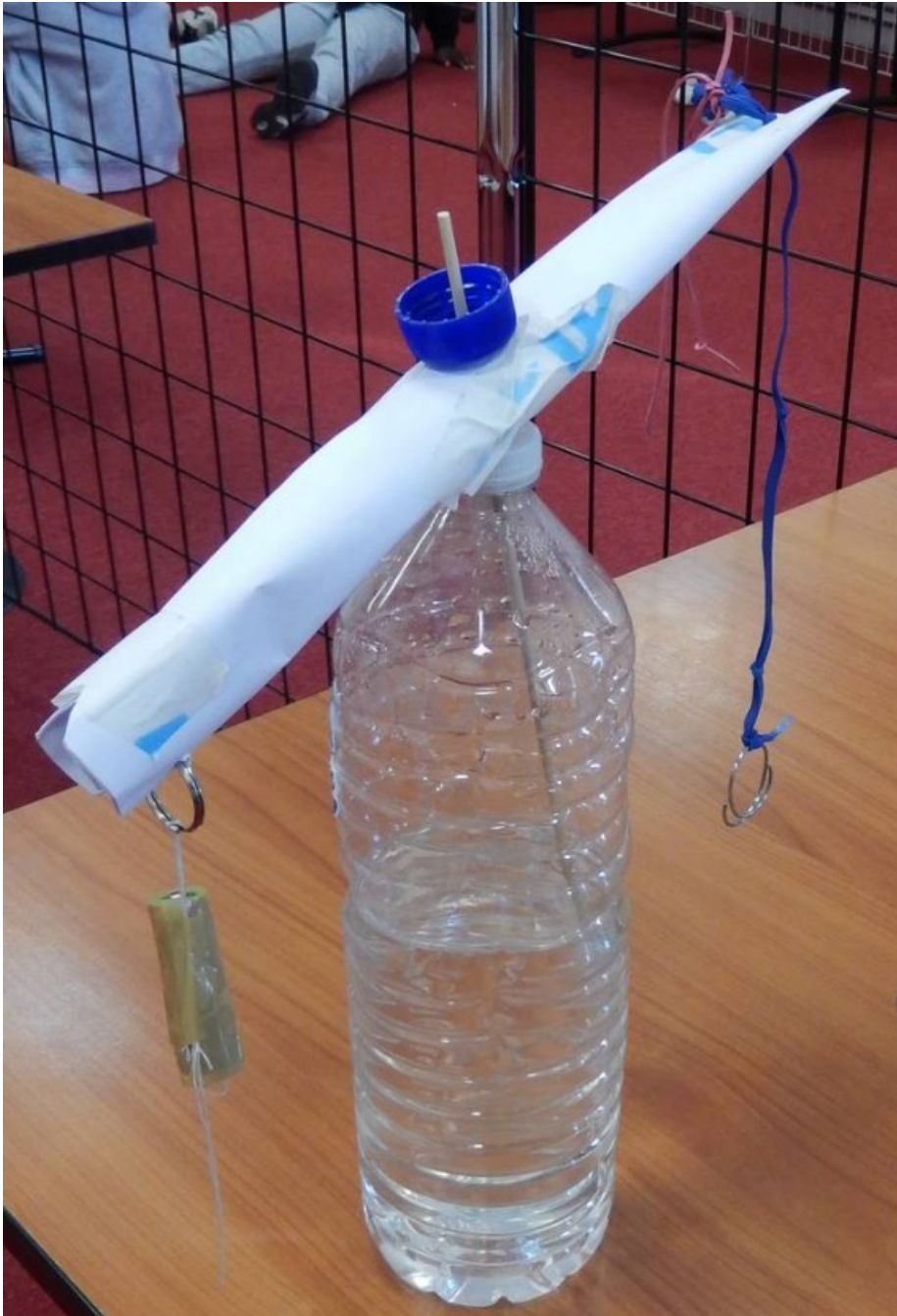
Mat lesté, contreponds : rotation facile, mais pas de dispositif de levage
