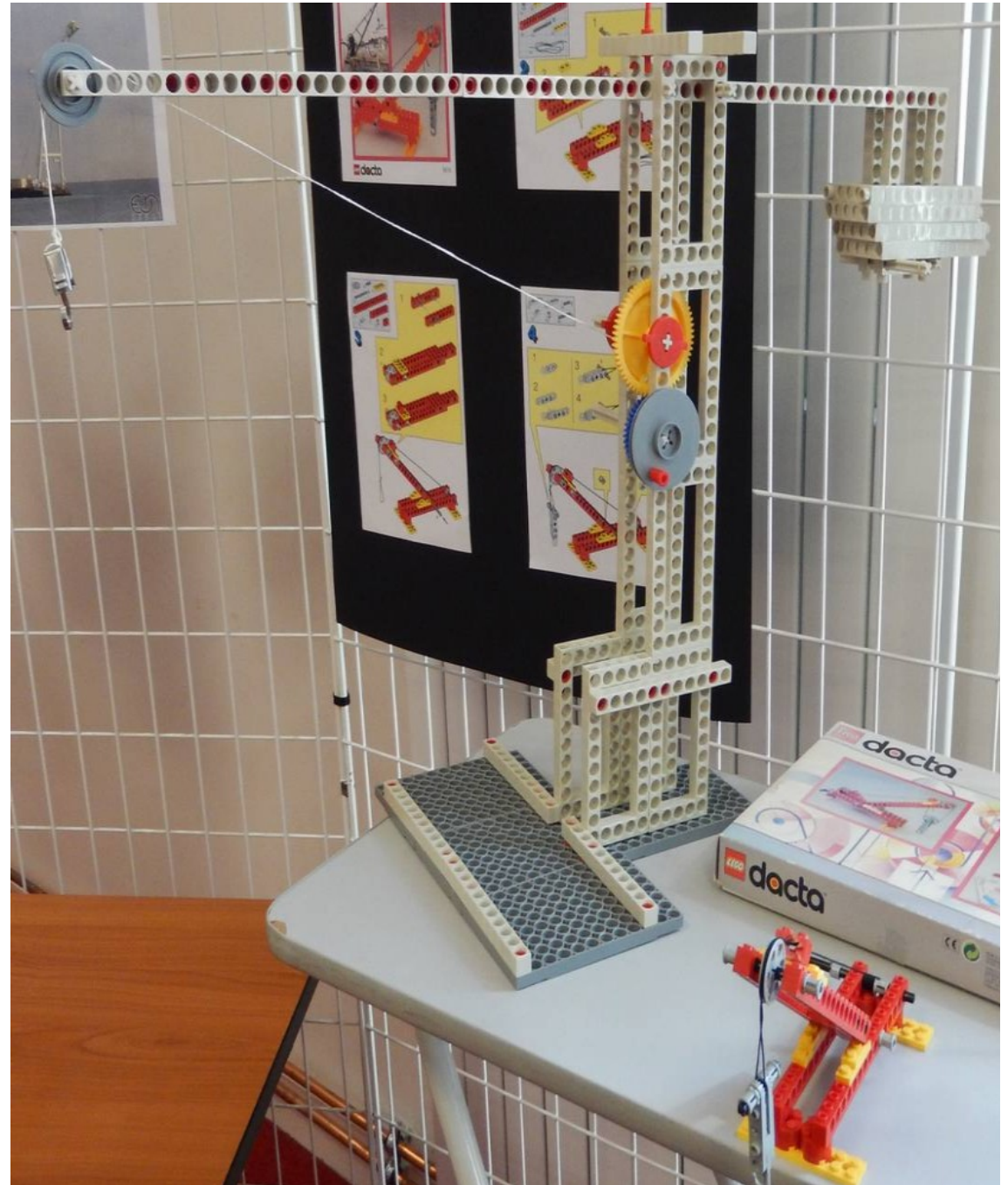
Grue réalisée avec du matériel Celda, mettant en jeu poulies et engrenages
