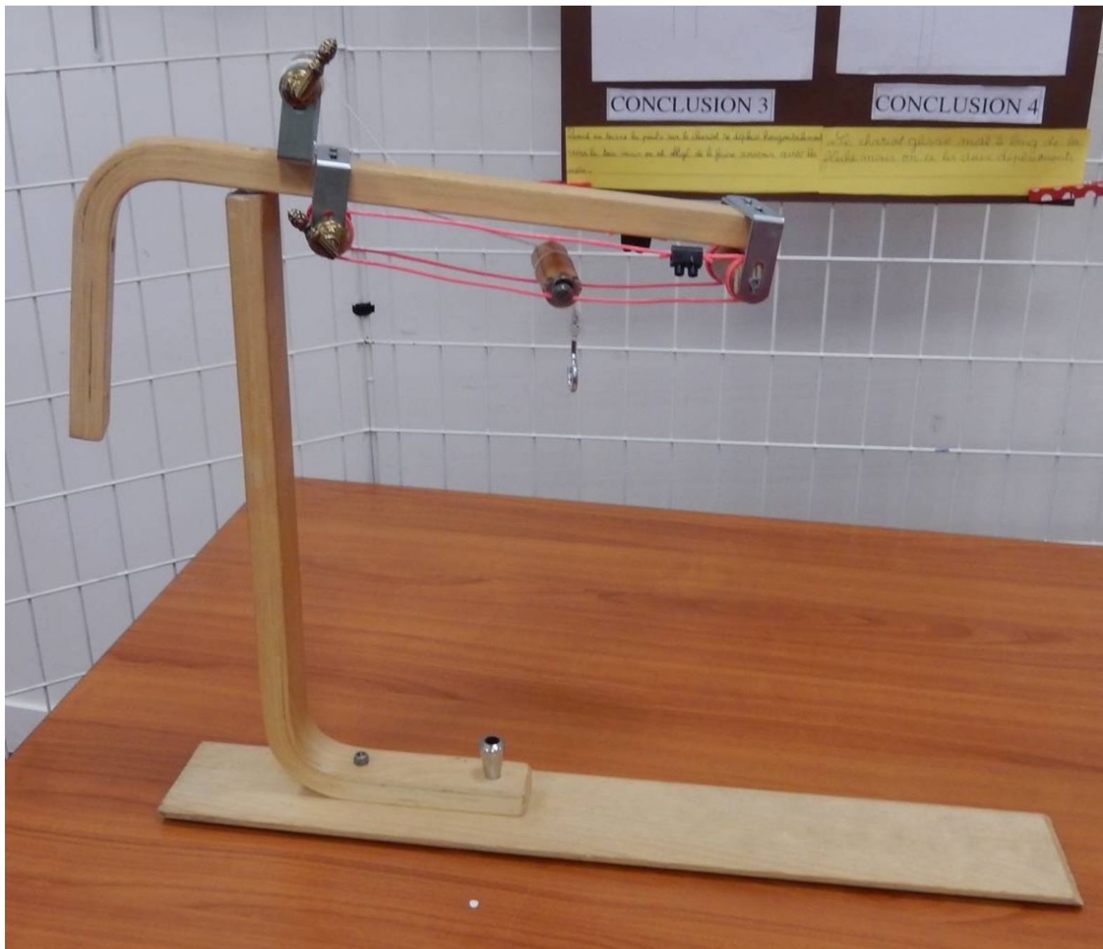
Poulies à base de bouchons de liège, manivelles en crochets à rideaux, domino électrique pour fixer les câbles...
