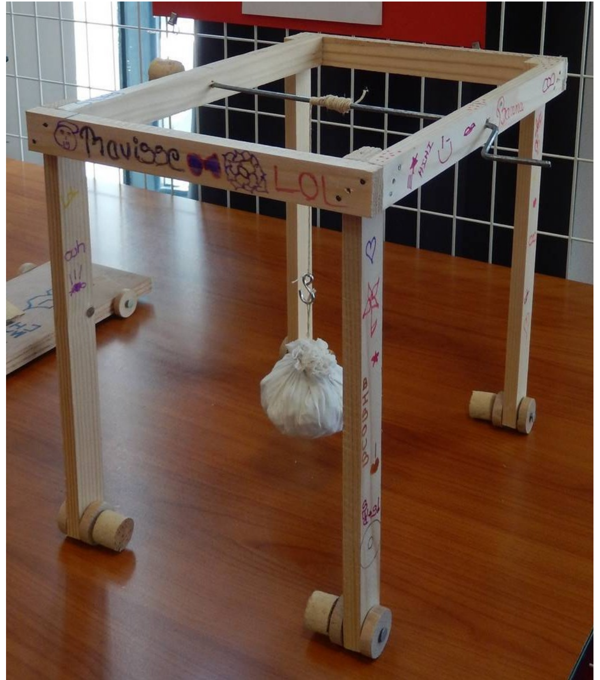
Portique roulant équipé d'un treuil : permet le levage et le déplacement
