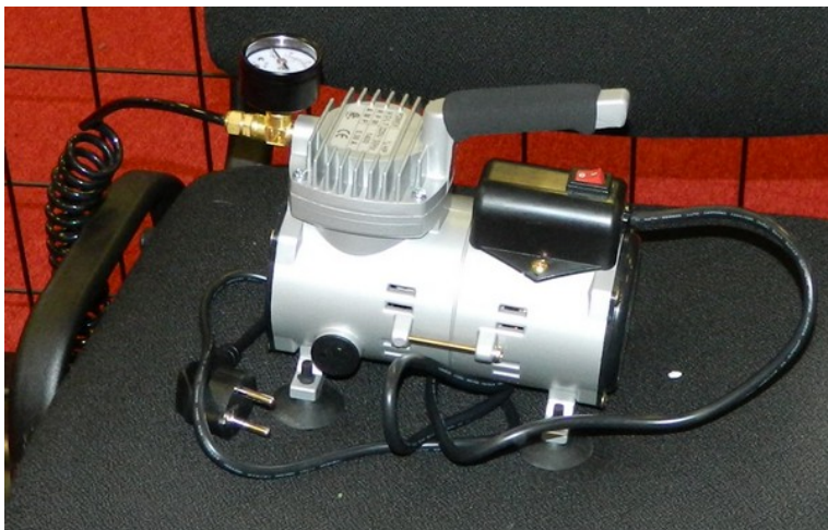
Compresseur permettant une mise en pression à distance (sécurité)
