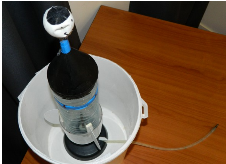
Prototype muni d'une ogive (entonnoir surmonté d'une boule) placé dans un seau.
